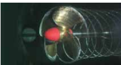
Kavitasjonstest av propellmodell
