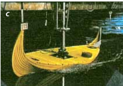
Modellprøving av Osebergskipet i skala 1:10, utført av MARINTEK i skipsmodelltank ved Marinteknisk Senter i 2009.
