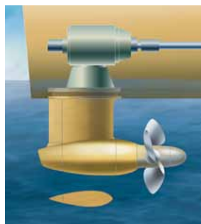
Kraftoverføring til propell i hurtiggående fartøy
